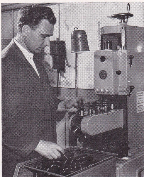
Prüfen und automatisches Sortieren von Ventilfevern auf Federprüfmaschine mit Elektro-Signaleinrichtung.
