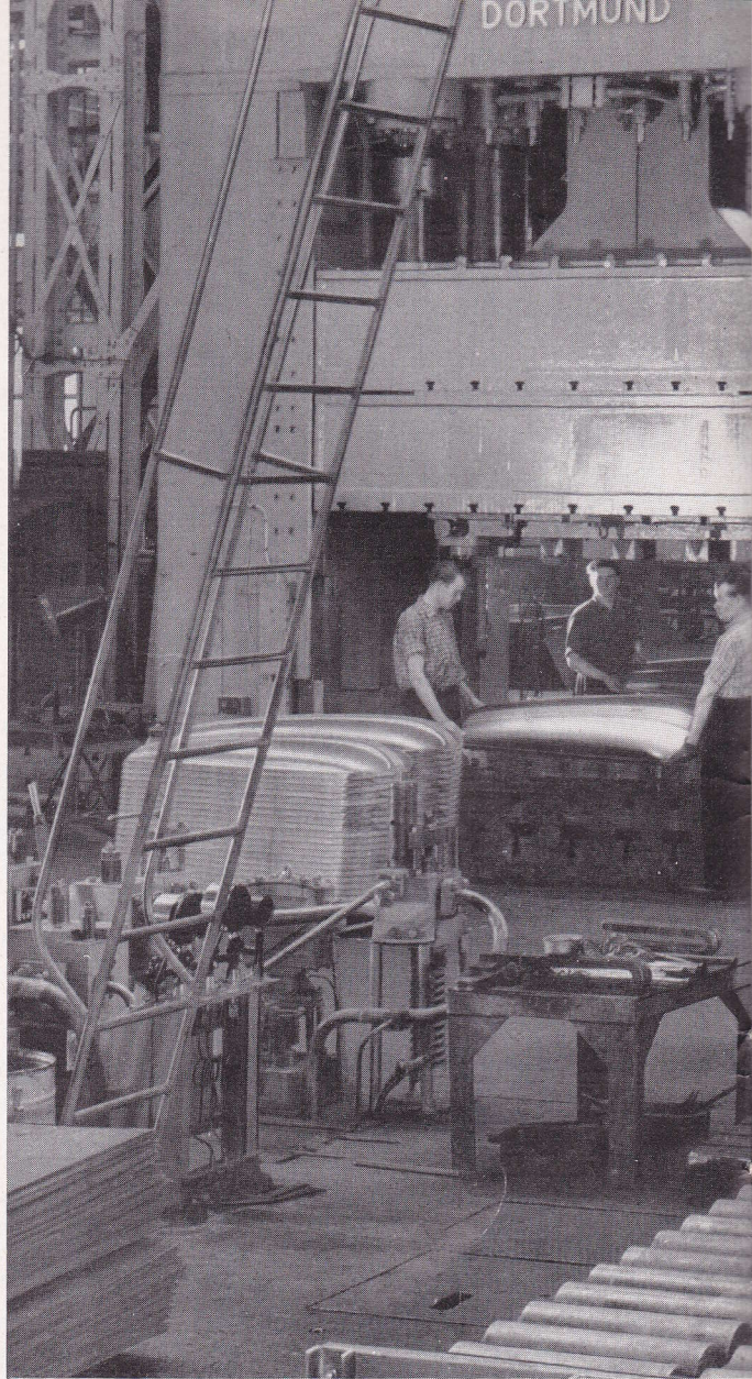
Hydraulische 1300-t-Tiefziehpresse. Sie formt
