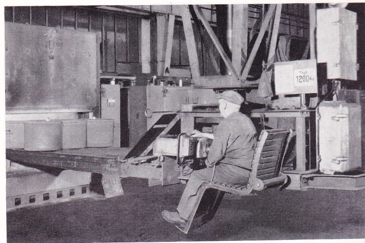
Einfahren von Materialbehältern in die Glühöfen der Härterei.
